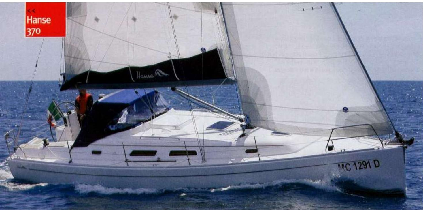
Armato con randa steccata e fiocco autovirante, l'esemplare in prova ha dimostrato un ottimo comportamento già con 10 nodi di vento reale.
